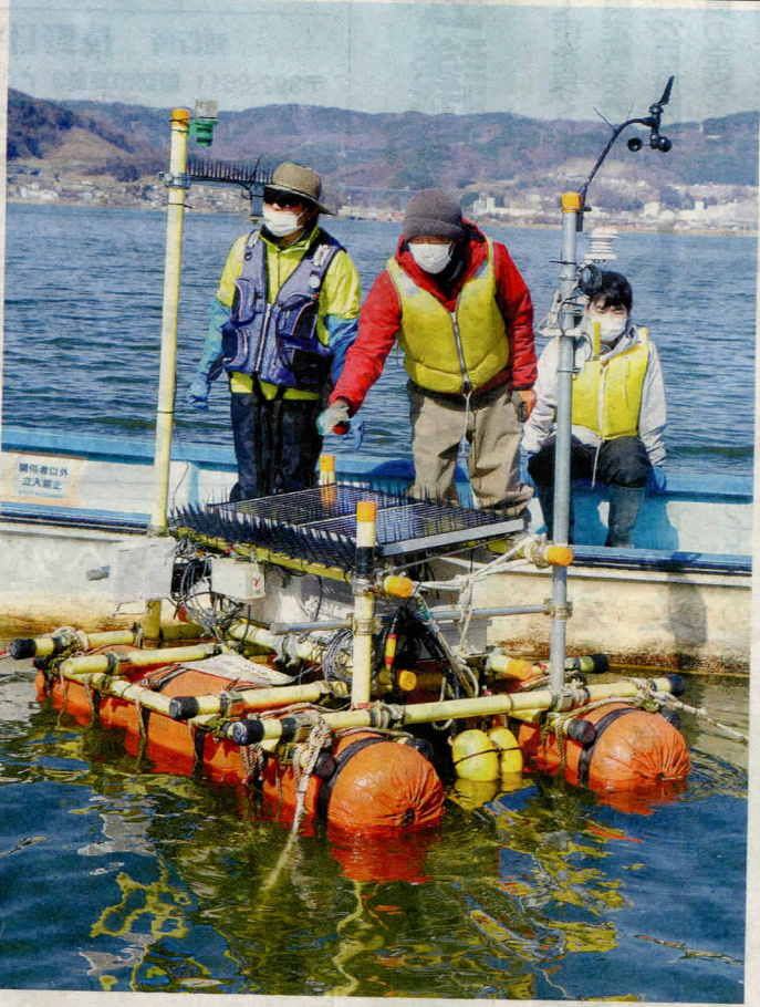
SSS5.0が諏訪湖上に設置した水質調査機器
